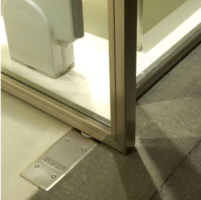
Bisagras hidráulicas GEZE, variantes TS 500 N-EN3 Fuerza fija y TS 500 NV Fuerza regulable, para ancho de hoja máximo de hasta 1150mm y un peso máximo de 150Kg. Caja con una altura de tan solo 42 mm, perfecta para instalación tanto en proyectos nuevos como en remodelaciones.
